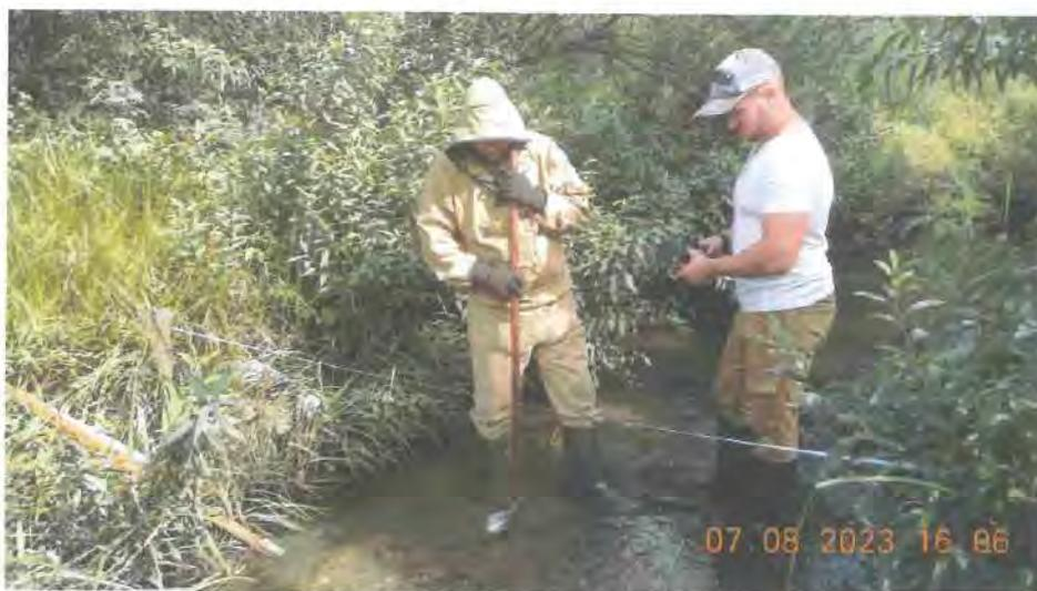
Рисунок 20 – Измерение скорости воды. Вид гидрологического поста «Заказчика»
