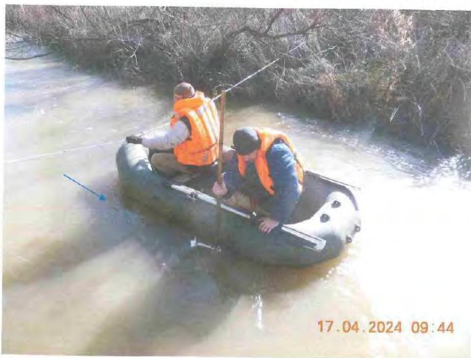
Рисунок 12 – Определение скорости потока вертушкой № 1649 измерительного комплекса
