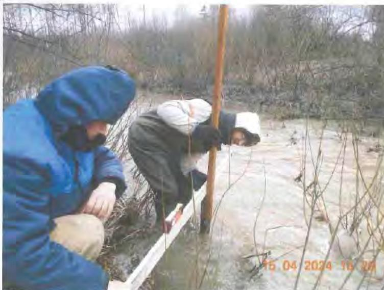
Рисунок 13 – Измерение уровня воды по свае № 5. Вид гидрологического поста «Заказчика»
