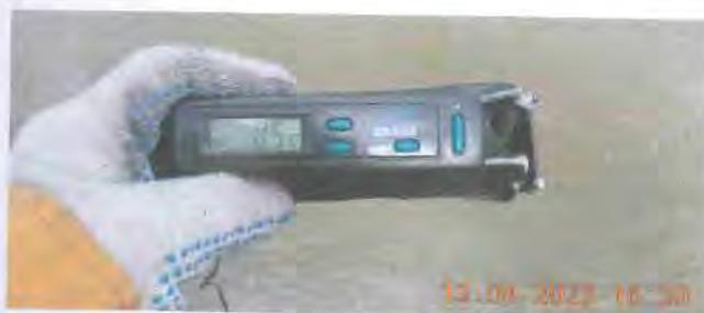
Рисунок 17 – Измеренная температура воды на посту равна 0,5<sup>0</sup>С.
